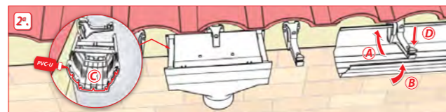
2°. Coloque a caleira encaixando-a por baixo do suporte / gancho de caleira (A), verifique se o perfil de fixação está corretamente colocado e encaixe o bordo exterior da caleira no suporte / gancho de caleira (B). Não os fixe, pois isso permitirá o movimento da caleira em ambos os sentidos durante o processo de instalação. Aplicar uma camada uniforme de cola PVC-U apenas nas extremidades dos elementos a serem colados (C). A colagem deve ser efetuada consecutivamente a partir de uma união até um tampão. Certifique-se de que todos os elementos são colados, e finalize encaixando o suporte no lugar (D).
