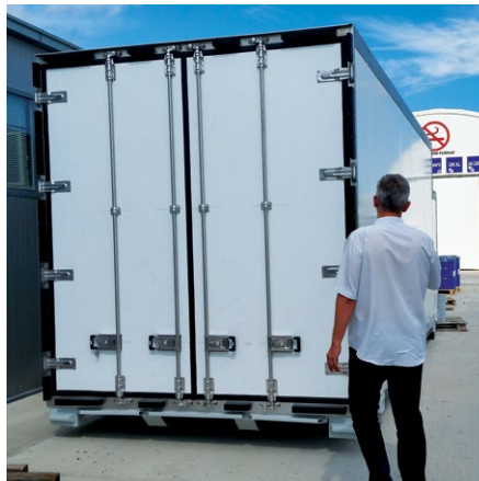
FIBRANxps FABRIC como isolamento térmico de contentores de transporte e caravanas
